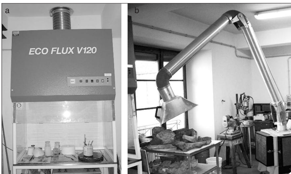
Fig. 7. Sistemi di aspirazione: a) cappa aspirante, b) naso aspirante.
