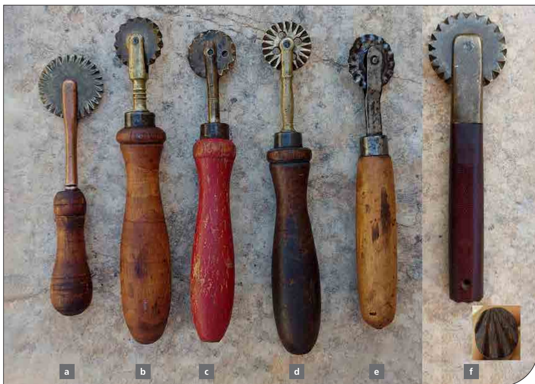
Fig. 6. Sei speronelle da pasta in metallo: a) in ottone, rame e legno; b) in ottone e legno; c) in ottone, ferro e legno; d) in ottone e legno; e) in legno e lamiera; f) in ottone e legno, da notare lo stampo a forma di conchiglia alla base del manico. Collezione del Museo Storico Culturale Kamemi.
