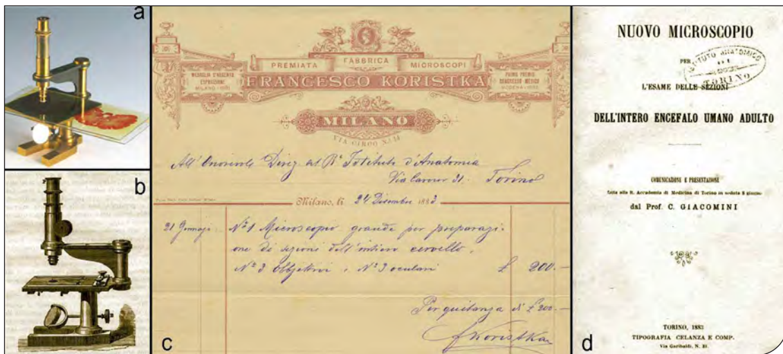
Fig. 1. Museo di Anatomia umana "Luigi Rolando" dell'Università di Torino. a) Microscopio con grande piano di appoggio costruito dalla ditta Koristka su progetto di Giacomini, utilizzato per osservare le sezioni in toto di encefalo; b) disegno del microscopio (a) figurato nella specifica pubblicazione (d); c) fattura di acquisto di uno dei microscopi, Ditta Koristka, 24 dicembre 1883; d) frontespizio della pubblicazione dedicata a questo microscopio.
