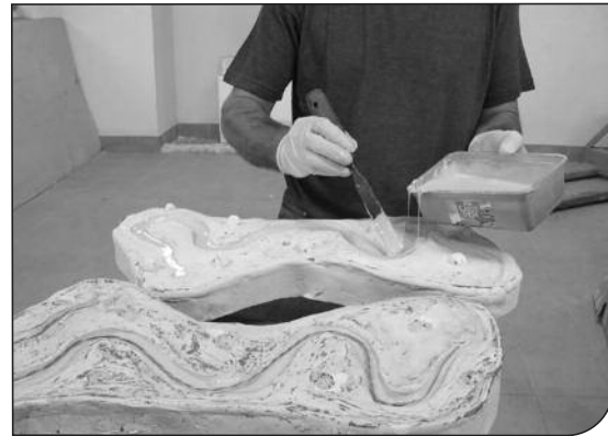
Fig. 11. Preparazione del calco di un boa arcobaleno: le due metà dello stampo in gesso durante la colatura della gomma siliconica. Delle guide per l'allineamento consentono di far combaciare perfettamente le due forme al momento della chiusura dello stampo. Notare l'armatura in filo di acciaio parzialmente immersa nella gomma in una delle metà dello stampo.
