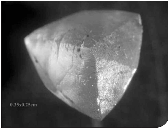
Fig. 1. Diamante A40. Immagine allo stereomicroscopio, il cristallo è un geminato per contatto (macle), sulla superficie sono ben visibili le ancillary ridges.
