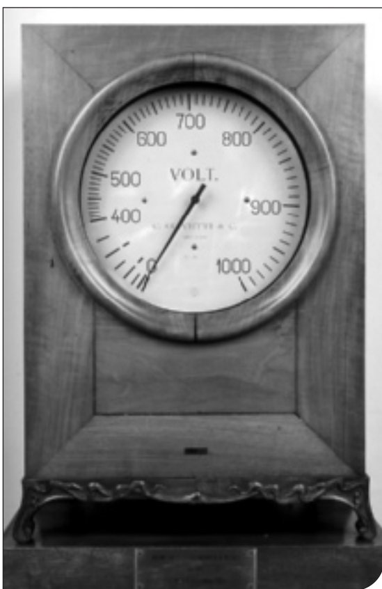
Fig. 2. Voltmetro elettrodinamico a relais. C. Olivetti & C. - C.G.S., Milano, 1905.
