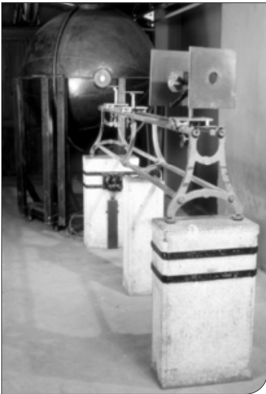
Fig. 5. Banco fotometrico e sfera di Ullbricht (Schmidt e Siemens), 1898.
