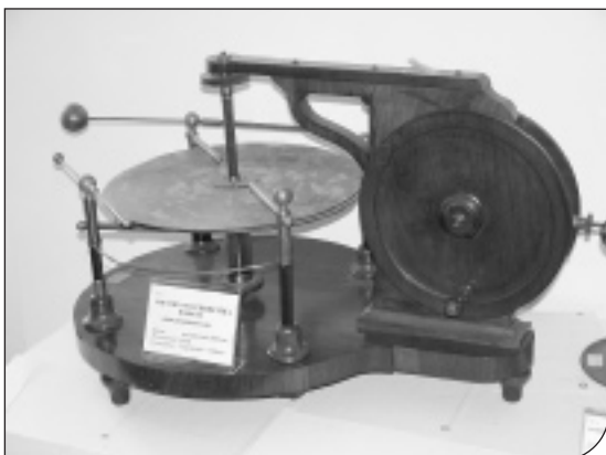
Fig. 2. Collezioni del Liceo Classico "G.D. Cassini" di Sanremo (Imperia). Una macchina elettrostatica di Holtz, a dischi orizzontali, della seconda metà del XIX sec. Si tratta di una macchina elettrostatica a induzione usata per separare le cariche elettriche e produrre alte differenze di potenziale elettriche.
