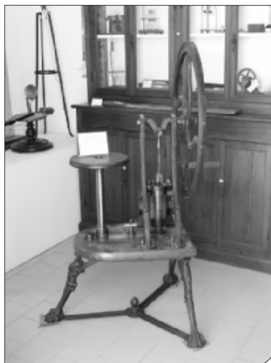
Fig. 3. Collezioni del Liceo Classico "G.D. Cassini" di Sanremo (Imperia). Macchina pneumatica costruita nel 1880 da Tecnomasio Milano.
