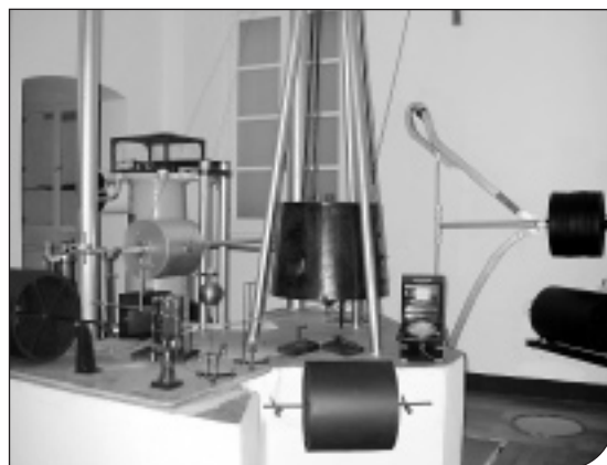
Fig. 9. Collezioni del Seminario Vescovile di Chiavari (Genova). Veduta d'insieme della sala macchine dell'Osservatorio Sismologico (dopo il restauro). Oltre ai sismografi, sul pilastro isolato di calcestruzzo, sono disposti due avvisatori di scossa sismica ed il cronometro nautico trasmettitore.
