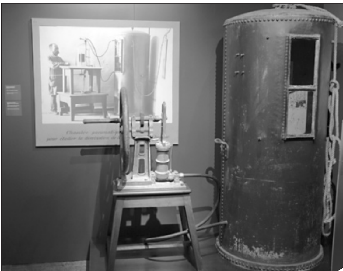
Fig. 2. Spazio espositivo dedicato alle ricerche di Angelo Mosso nella mostra "La memoria della scienza" (Torino, 2004) con la campana di decompressione (ora conservata presso l'Archivio) che venne realizzata per la simulazione delle alte quote in laboratorio (Galloni, 2003).
