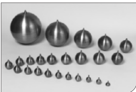
Fig. 3. Dipartimenti di Fisica dell'Università di Torino. Serie di "risuonatori di Helmholtz" (seconda metà del XIX secolo). Si tratta di apparati per l'analisi delle armoniche presenti in un suono, costituiti da globi cavi di ottone capaci di rinforzare esclusivamente i suoni per i quali sono stati accordati. Ogni globo ha due aperture: una ampia che funge da padiglione, l'altra di dimensioni tali da poter essere introdotta nel condotto uditivo dello sperimentatore.
