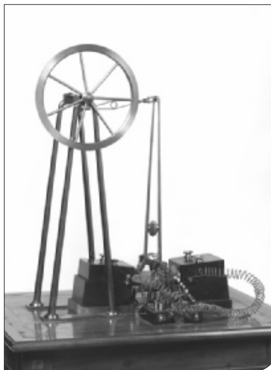
Fig. 2. Dipartimenti di Fisica dell'Università di Torino. Motore elettrico a corrente continua progettato da Domenico Botto (1834-1836) e costruito da E.F. Jest. Lo strumento, destinato a scopo didattico, rappresenta uno dei primi motori elettrici al mondo.
