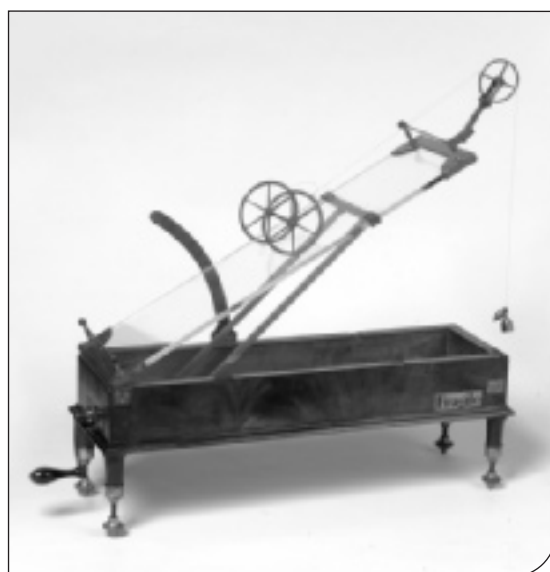
Fig. 4. Dipartimenti di Fisica dell'Università di Torino. Modello di piano inclinato per esperienze di meccanica (seconda metà del XIX secolo). Il carrellino è libero di scorrere su un ripiano di vetro inclinato, ma è mantenuto in posizione di equilibrio da un peso a lui collegato che pende dalla carrucola. Variando l'inclinazione del piano è necessario variare il peso per mantenere la posizione di equilibrio.
