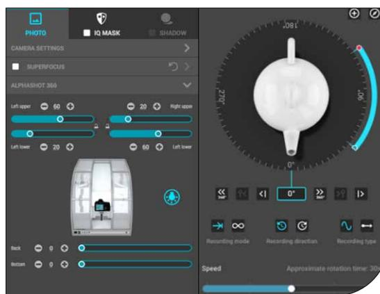
Fig. 1. Schermate relative al controllo del sistema fotografico e del tavolino rotante da PC (Orbitvu station).
