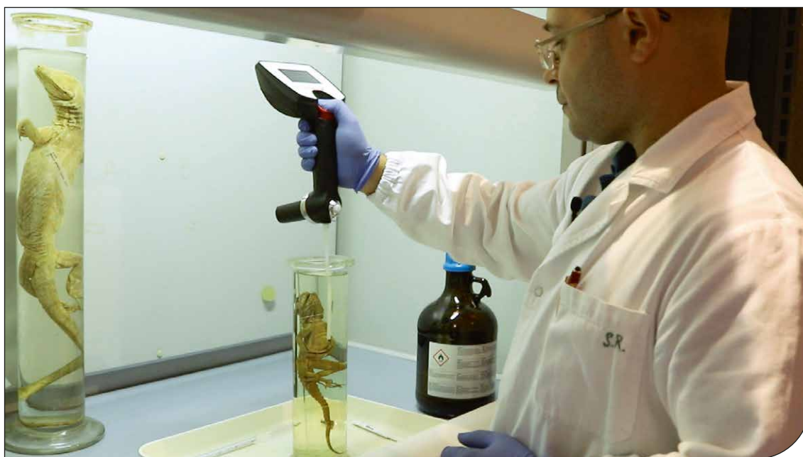
Fig. 1. Titolazione dell'alcol per mezzo di un alcolometro digitale di precisione.
