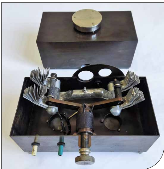
Fig. 13. Lampada a vapori di mercurio prodotta dalla Original Hanau, Germania, a partire dal 1920 circa (Collezione Storica degli Strumenti di Fisica, Università di Palermo).
