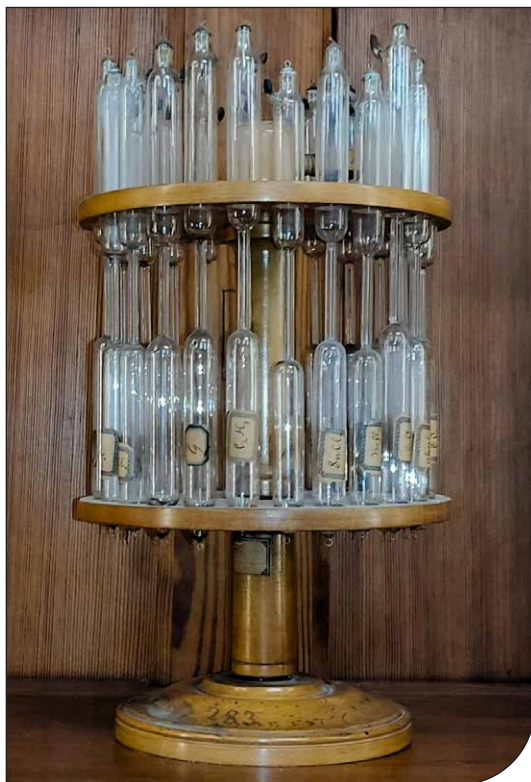
Fig. 12. Tubi di Plücker contenenti vari gas, costruiti alla fine del XIX secolo (Collezione Storica degli Strumenti di Fisica, Università di Palermo).
