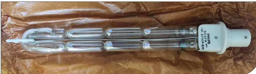
Fig. 14. Lampada a vapori di sodio Philips SO 60W TYP. 57004 B/01 prodotta e commercializzata dalla Philips a partire dal 1932; le macchie di colore metallico sono sodio solido (Collezione Storica degli Strumenti di Fisica, Università di Palermo).
