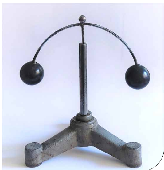
Fig. 11. Apparato dell'equilibrista per illustrare la condizione di equilibrio stabile.
