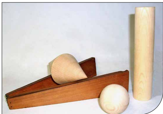
Fig. 9. Il doppio cono che sale sul piano inclinato; il cilindro e la sfera completano l'apparato.
