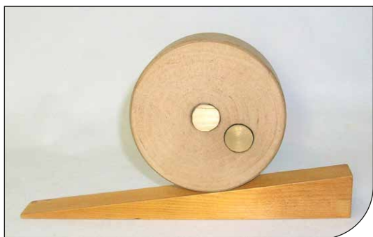
Fig. 10. Il cilindro con zavorra in equilibrio sul piano inclinato.
