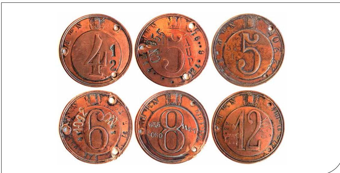
Fig. 7. Bolli metallici, primo tipo: è presente in alto al centro di ogni bollo l'emblema di Stato rappresentato dallo stemma sabauda, al centro il cerchio che riporta il numero preconciato (in questi casi, della pressione massima), in alto a sinistra la scritta "N.° DI P.°" (con numero di protocollo punzonato) e in alto a destra la data punzonata della visita.
