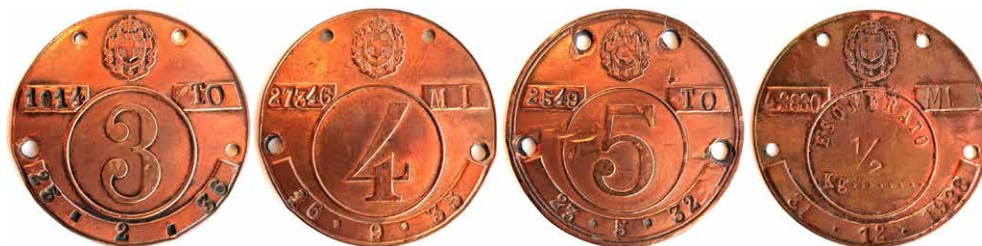
Fig. 9. Bolli metallici, terzo tipo: in questo tipo la disposizione degli spazi per le punzature è uguale al precedente; l'emblema di Stato è in alto al centro, più in basso, a destra e sinistra, due spazi per il numero di protocollo e la sigla della provincia, il cerchio centrale è ridotto di diametro rispetto al primo tipo e vi è preconiato o punzonato a mano il numero espresso in kg/cm 2 della pressione, vi può essere inoltre la scritta "ESONERATO" nella porzione alta del cerchio; inferiormente vi è uno spazio destinato alla data della visita.
