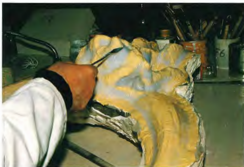
Fig. 2. - I sottosquadri sono eliminati mediante applicazione di gomma a stucco.
