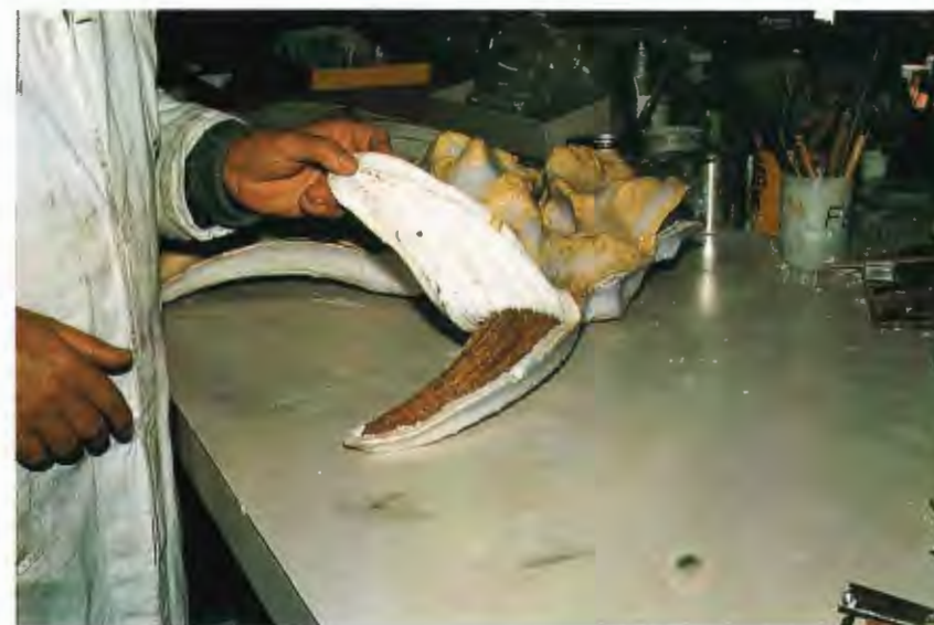
Fig. 3. - Distacco della gomma dall'originale.
