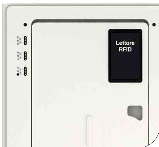
Fig. 3. Posizione del lettore RFID per il riconoscimento delle tavole tattili (per gentile concessione di ALO s.r.l.).
