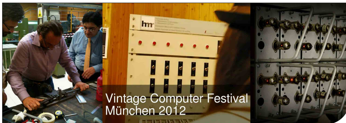
Fig. 2. La replica fisica dell'addizionatore a 6 bit del 1956: i ricostruttori al lavoro, in mostra al 13° Vintage Computer Festival di Monaco, dettaglio dei circuiti a valvole.
