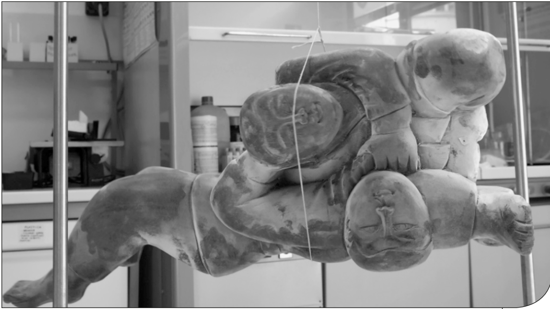
Fig. 5. Individuazione del baricentro ottenuta sospendendo la statua.
